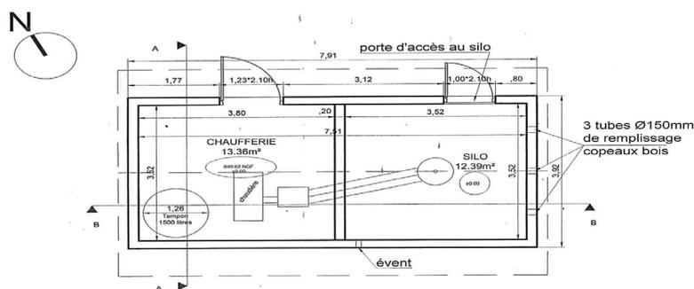
Le nouveau bâtiment est composé de 2 parties : le silo et la chaufferie. Le remplissage du silo se fait en soufflant les copeaux de bois (livraison d'un volume de 30 m<sup>3</sup> de copeaux de bois). Un contrat d'approvisionnement en combustible biomasse (bois déchiqueté) a été passé avec l'Entreprise TOUYRE. La chaudière, quant à elle, a une puissance de 75 kW
